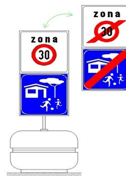
**Per strade a senso unico in entrata**, quindi riportanti solo i segnali in entrata "inizio zona 30" (più un'altra indicazione utile). Queste porte vanno collocate almeno a 3 metri dall'inizio della via, in modo da permettere un minimo spazio di invito al veicolo entrante.
